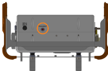
Imagen 5-21. Vista inferior PR5-TT. Botón de calibración de la pantalla táctil
